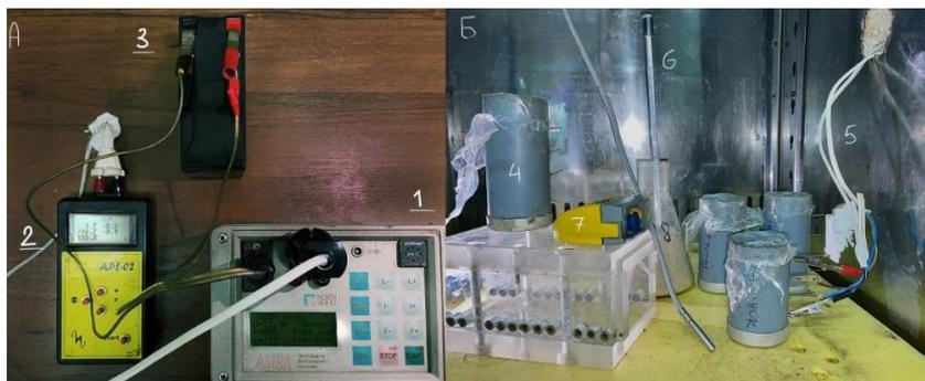
Рисунок 1. А) Установка для электромагнитного просвечивания; Б) морозильная камера с исследуемыми образцами
