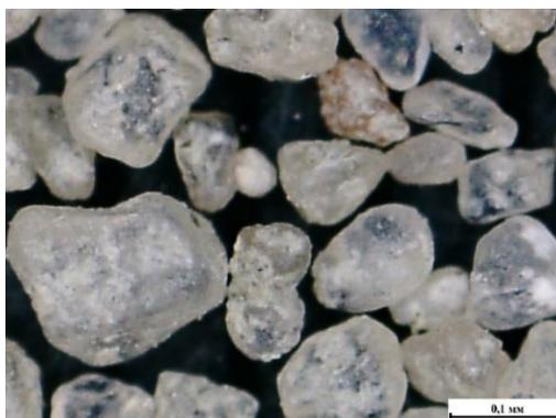
Рисунок 1. Песок с искусственно нанесенной глинистой поверхностной пленкой
