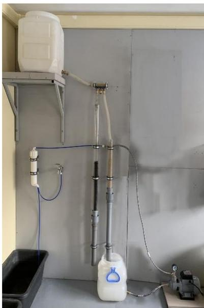
Рисунок 2. Установка фильтров и обратного осмоса
