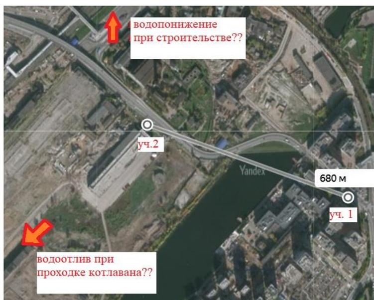
Рисунок 3. План-схема расположения участков проведения ОФР и направления к предполагаемым возможным объектам водопонижения
