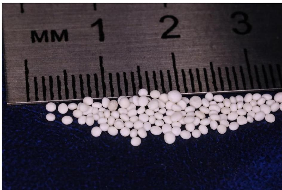
Рисунок 1. Внешний вид минерала струвита, полученного в ходе экспериментов с модульным раствором
