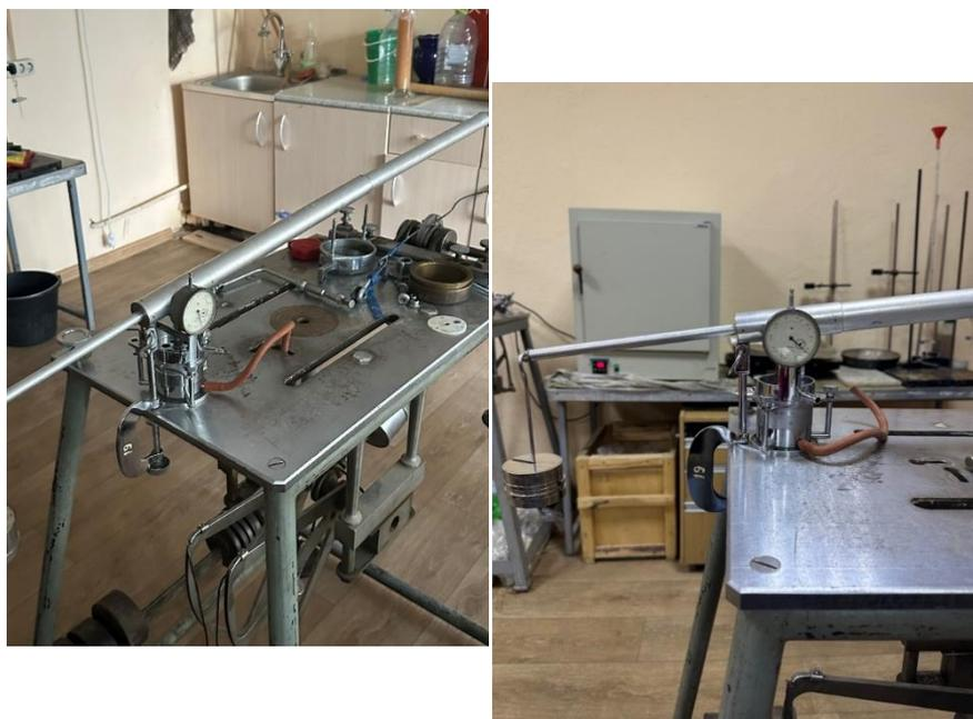
Рисунок 2. Общий вид компрессионного прибора полевой лаборатории в работе
